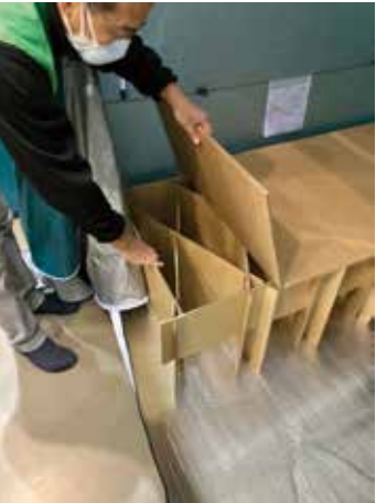
写真2 段ボールベッドは、長期使用していると湿気で弱くなったり、構造上ある方向からの力に弱いものがあった。
